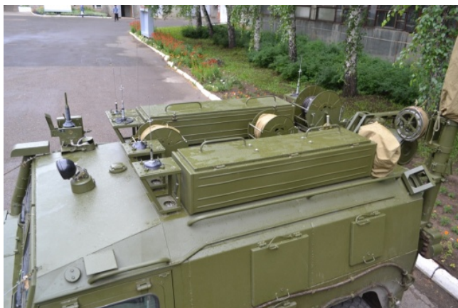
Рисунок 11 Крепление внешнего оборудования аппаратной связи
