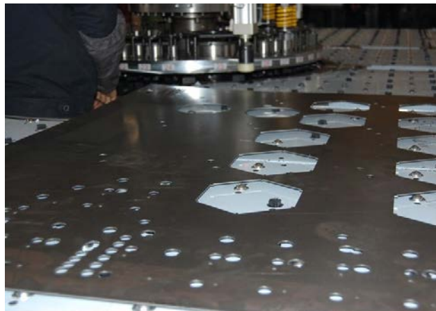
Рисунок 2 Отверстия, изготовленные методом пробивания
