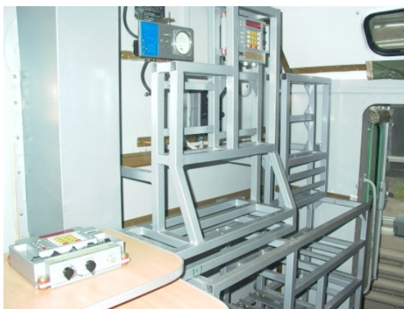
Рисунок 10 Крепление внутреннего оборудования аппаратной связи
