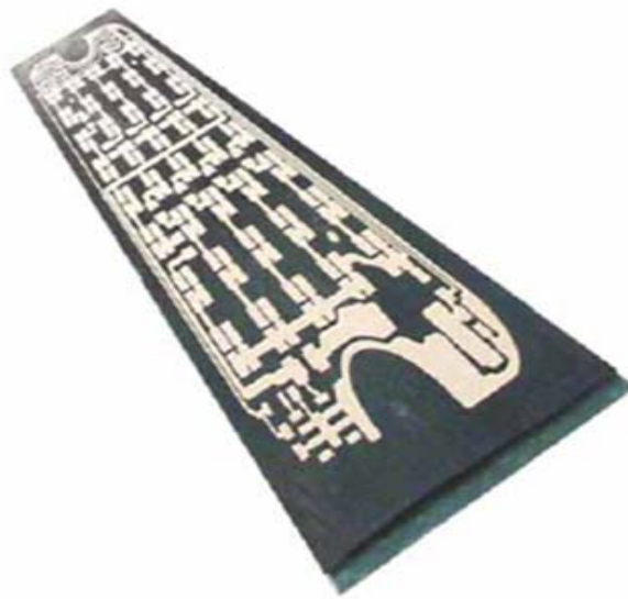
Рис.3. ПП на основе материалов CoolPoly компании CoolPolymers [4]
