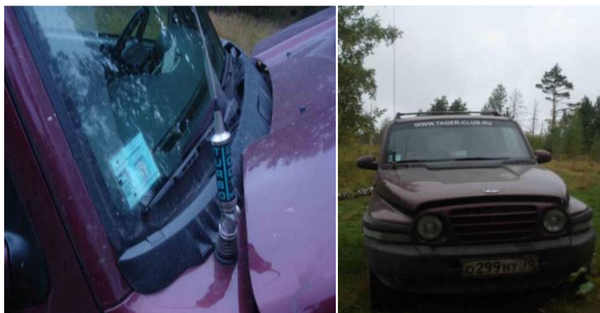
Рисунок 6. Размещение антенны LemmAT 2001 Turbo передней части автомобиля
