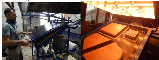
Рисунок 2. Установка и нагрев листа
